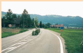
Porte à l'entrée du village
